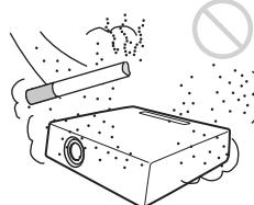
Vermeiden Sie die Installation des Geräts in sehr staubiger oder extrem rauchiger Umgebung. Andernfalls setzt sich der Luftfilter zu, was zu einer Funktionsstörung oder Beschädigung des Geräts führen kann. Ein mit Staub zugesetzter Luftfilter kann einen Anstieg der internen Temperatur des Geräts verursachen. Reinigen Sie den Filter regelmäßig.
